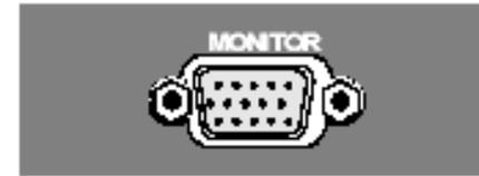
外接的VGA显示器可以通过15针SUB-D连接头连接到CMU200。
