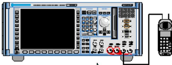
第一步：将已经插上SIM卡的移动台通过射频线连到CMU200的射频端口RF2。
